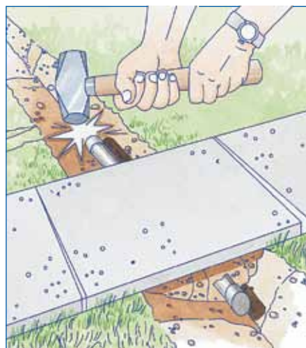
Pievienojiet cauruli zem celiņiem vai iebrauktuvēm, ar āmuru tās "izdzenot" to pa apakšu šiem celiņiem.
